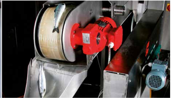
Helautomatisk vaksineringsmaskin som kan betjenes av en enkelt operatør, og kan håndtere opp til 20.000 smolt i timen. Brukes av alle verdens største aktører innen lakseoppdrett.
