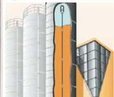
Temperaturkabler/temperaturovervåking til siloer og planlager.
