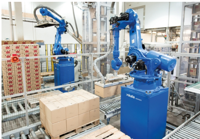
Plassforholdene har stilt store krav til løsningen, slik at robotens arbeidsområder, baner og paller ikke kommer i konflikt med øvrig utstyr og aktiviteter. Foto: Automatiker & Fotograf, Jon Schioldborg Baglo.
