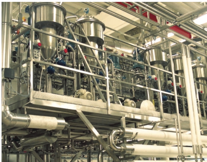
Den kontinuerlige brunostlinjen har kapasitet til å produsere 3.000 tonn årlig av ulike typer brunost.
